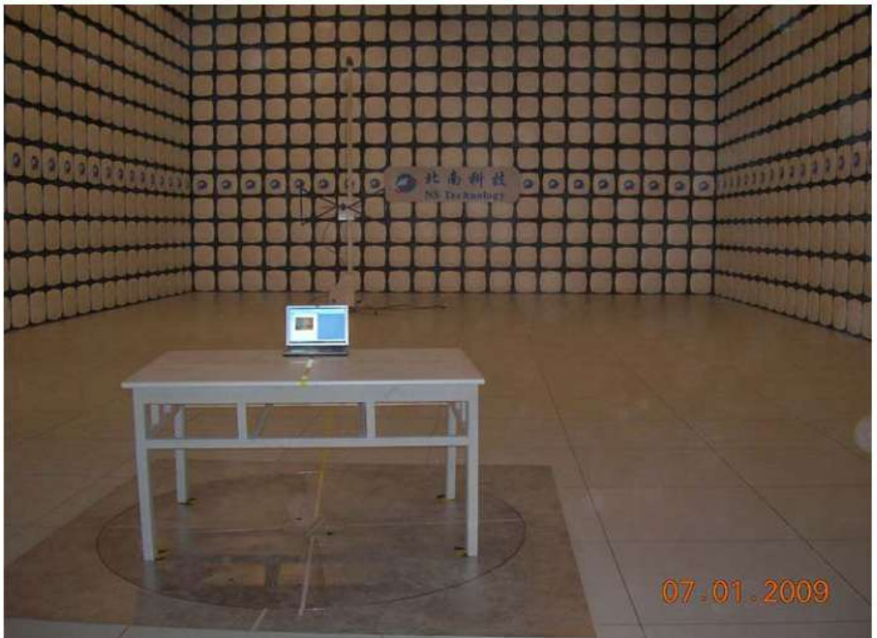
© 深圳北南科技实验室 10 米法半电波暗室
